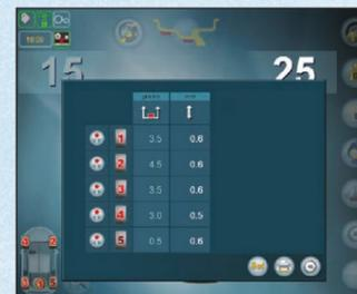
AAM per ogni singola ruota, il software acquisisce peso e dimensioni e ricalcola il valore di tolleranza tale da annullare ogni vibrazione percepita sul volante. Garantisce il massimo confort alla guida del veicolo e, insieme ad OW, anche la minimizzazione dei tempi di equilibratura e dei contrappesi utilizzati.
