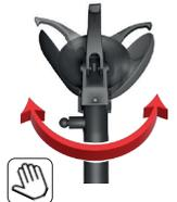
Handverstellbarer und umklipbarer Werkzeugtragarm und **manuelle** Verschiebung.
